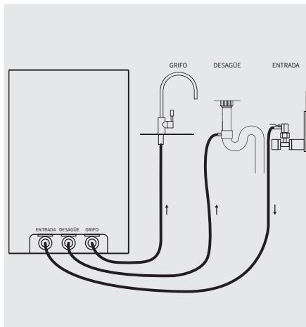
**Esquema de conexionado hidráulico**
